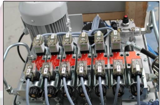
Compact hydraulic control unit für 6 cuvettes
